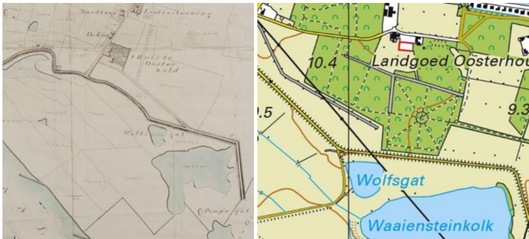
Afb. 12 De teruggelegde, hoekige dijk om de Waaisteinkolk en de afgesneden allee of kwelkade in 1811 (links) 19 en in 2023 (rechts) 20
