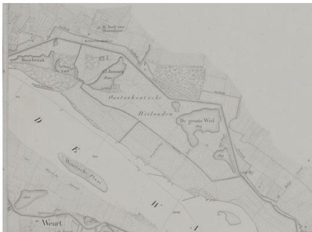
Afb. 14 De teruggelegde, rechte Oosterhoutse dijk en de nieuw aangelegde kwelkaden (Goudriaan, 1830)
